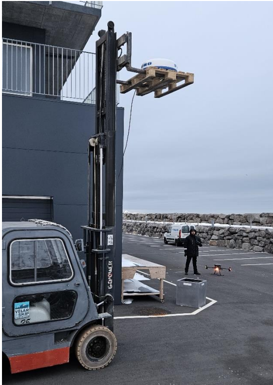
Mynd 6.40 Radar og tölvubúnaður af sömu tegund og sá sem staðsettur er á Garpsdalsfjalli var settur saman og var radarkúplinum lyft upp í 6 metra hæð og beint út á haf.
